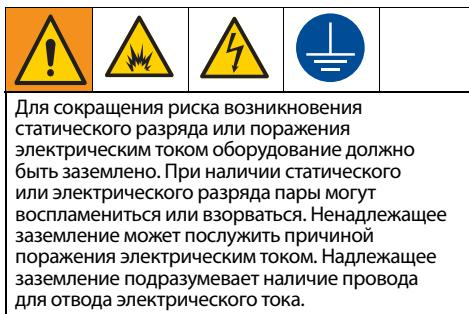
Этот распылитель имеет провод заземления с соответствующим контактом заземления. Вилка должна подключаться к розетке, надлежащим образом установленной и заземленной в соответствии со всеми местными правилами и нормативами.
