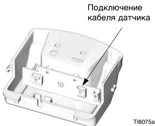
Рис. 15. Подключение кабеля датчика
