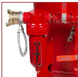
В стандартной комплектации все абразивоструйные аппараты GN-BLAST® оснащены высокоэффективным фильтром влагоотделителем GN CAF-3 для предотвращения попадания влаги и масла из компрессора в резервуар.
