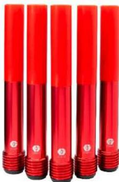
Пескоструйные сопла GN UBC XL имеют длину канала Вентури 350 мм. Благодаря этому участок разгона абразивоструйных частиц максимальный, кинетическая энергия частиц значительно больше и как следствие производительность данных сопел на 30-50% выше чем у пескоструйных сопел с классическим каналом Вентури. Единственным недостатком данных сопел является трудность использования в малогабаритных объемах.
