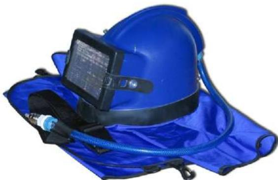
Легкий, комфортабельный и недорогой шлем предназначен для любого вида абразивоструйных работ. Конструктивное исполнение обеспечивает постоянный обдув стекла, предотвращая запотевание. Шлем оснащен регулятором давления, индикатором подачи сжатого воздуха и пелериной. В качестве сменного стекла в шлеме используется стекло, защищенное сеткой из нержавеющей стали.
