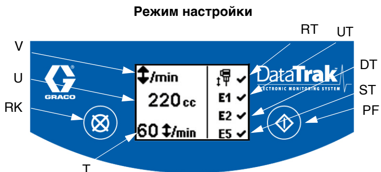
Рис. 5. Устройства управления модулем DataTrak и их индикаторы
