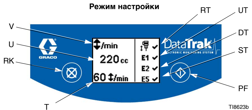
Рис. 3. Устройства управления модулем DataTrak и их индикаторы
