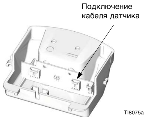
Рис. 15. Подключение кабеля датчика
